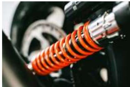
La principal aplicación son los dinamómetros, instrumentos utilizados para medir fuerza, cuya calibración se hace en base a la ley de Hooke. Otra aplicación indirecta corresponde al sistema de suspensión o amortiguadores de algunos vehículos de transporte.
